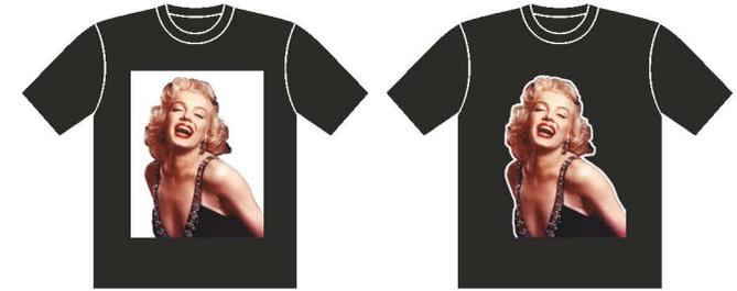
Laserprintfolien eignen sich für die Bedruckung farbiger und dunkler Textilien. Sie sind nicht transparent und bilden darum einen weißen Hintergrund um das Motiv (siehe linke Abbildung). Dieser kann mit einem Konturschnitt entfernt werden (siehe rechte Abbildung).
